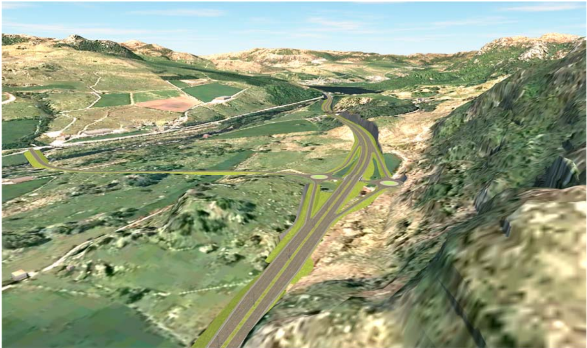
Figur 2-22. Illustrasjon av kryss på Holmen sør for Vikeså. Svelavatnet i bakgrunnen og tilknytning til dagens E39 via tilførselsveg fra krysset mot venstre.
