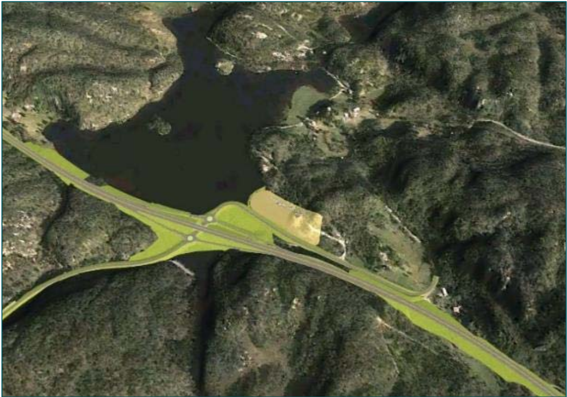
Figur 2-11. Modellert skisse av kryss ved Lølandsvatn med skissert område for døgnhvileplass for langtransportsjåførere. Mot Birkeland og Feda til høyre, og mot Sira til venstre. Ny fv. 466 mot Flikke ned mot vestre i illustrasjonen.
