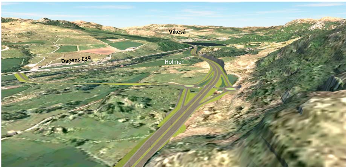
Figur 29. Illustrasjon av kryss på Holmen sør for Vikeså, i korridor R1 og variant V3a. Tilknytning til dagens E39 via tilførselsveg fra krysset mot venstre. Svelavatnet i bakgrunnen.
