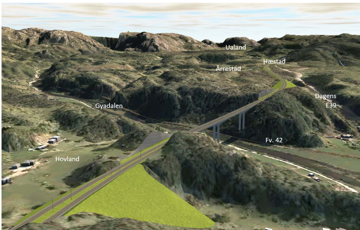
Figur 39. Illustrasjon av korridor R2, bru over Gyadalen. Gyadalen krysses noe lenger sør i korridor R2 enn i R1
