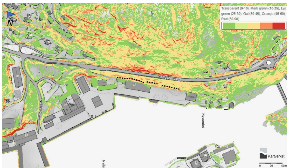
Figur 3.4. Helningsgrad i planområdet. Skråningen hvor det skal fundamenteres for å etablere gang- og sykkelveg ligger med en helning på mellom 30–45 grader. (Kilde: Norconsult, ingeniørgeologisk notat).
