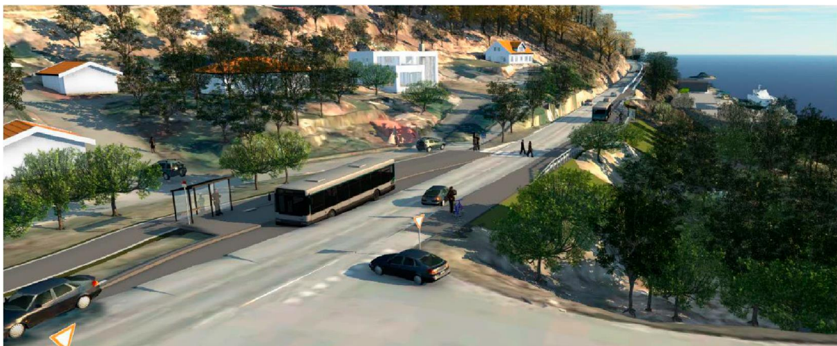
Illustrasjon av busslomme med GS-veien bak. GS-veiens kryssning i plan på gangfelt vises også i bakgrunnen.
