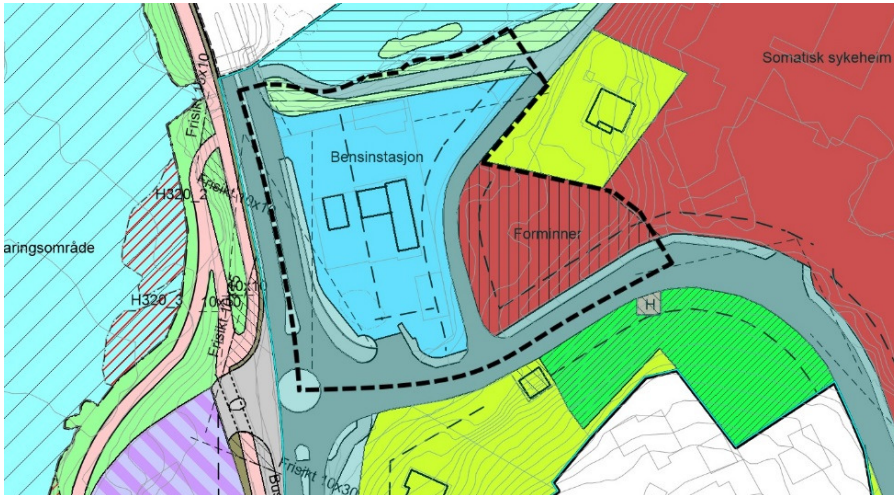
Figur 3: Gjeldende reguleringsplan for Kjerjanaset – Havsvø fra 1986. Areal avsatt til fornminne reguleres om til bensinstasjon med tilhørende anlegg. Plangrense for reguleringsendring er vist med svart stiplet linje. Kartkilde: www.eigersund.kommune.no
