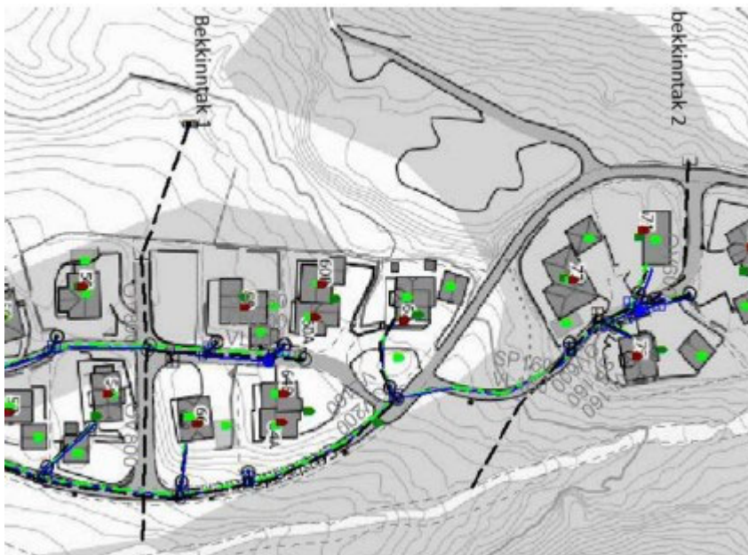
Figur 20: Eksisterende bekkeinntak i området. Kilde: Rammeplan for vann, avløp og overvann, Prodok 3D.
