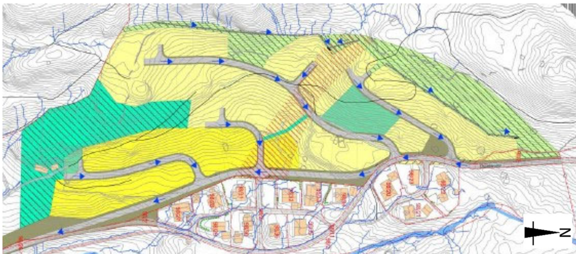
Figur 34: Nye flomveier etter utbygging er illustrert med blå pil. Kilde: Rammeplan for vann, avløp og overvann, Prodok 3D.
