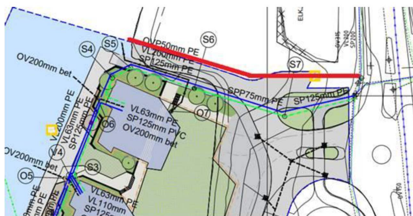
Figur 3: Ny planlagt kommunal overvannsrør, rød strek.
