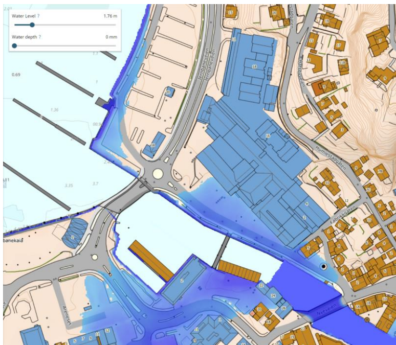
Figur 4 Utklipp fra Scalgo ved havnivå på 176cm, Sikkerhetsklasse 2 (tek10/17) med klimapåslag. Blå felt viser hvor det vil stå vann ved stormflo.
