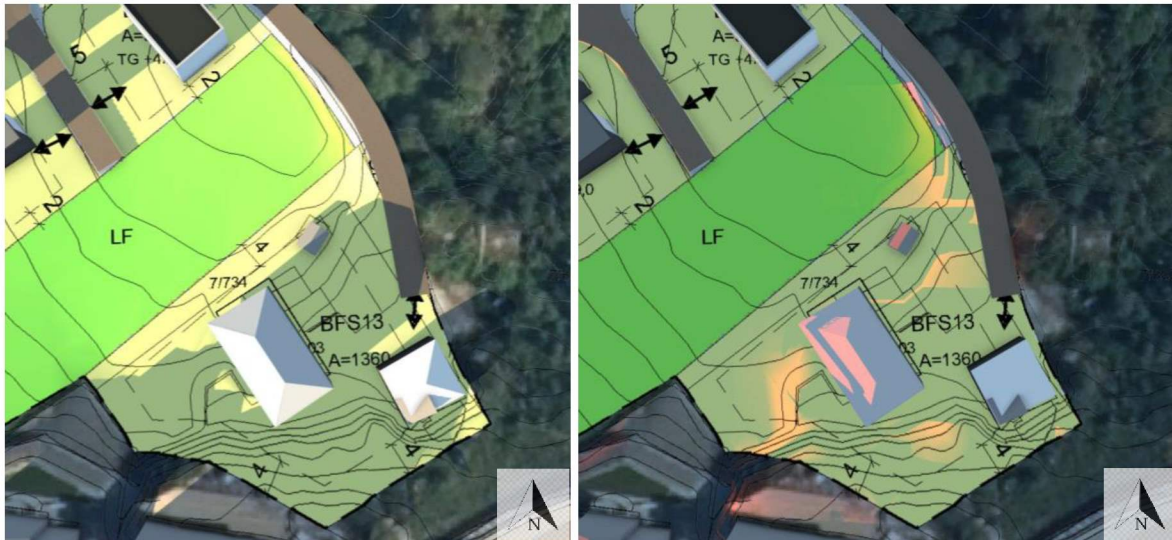
Figur 17: Soldiagram for Lasteinveien 18. Til venstre: Viser solforhold ved vår-høstjevndøgn kl. 15.00. Til høyre: Viser solforhold ved vår-høstjevndøgn kl. 18.00.
