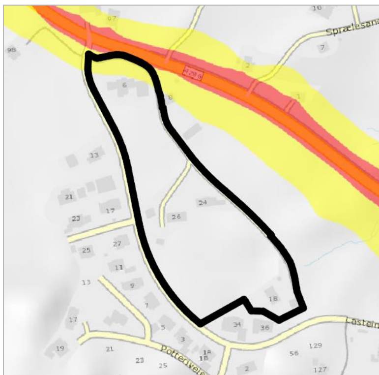
Figur 11 Viser støygrense fra fylkesveg. Kilde SVV vegkart.
