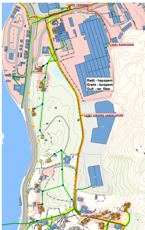
Kart høyspent, lavspent og fiberkabler
