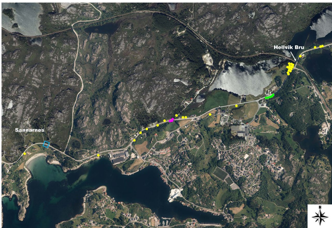
Figur 2-1. Oversiktskart over planområdet som viser grunnundersøkelser utført for prosjektene Fv.44 Hellvik-Vassvik og Fv.44 Hellvik Bru (mai/juni 2020). Disse er markert som gule punkter (totalsonderinger) og grønne punkter (miljøprøver). Tidligere undersøkelser utført for Hellvik- og Sannarnes bru (1981) er markert ved henholdsvis rosa punkter og turkis firkant (nøyaktig plassering av disse borpunktene er ukjent).
