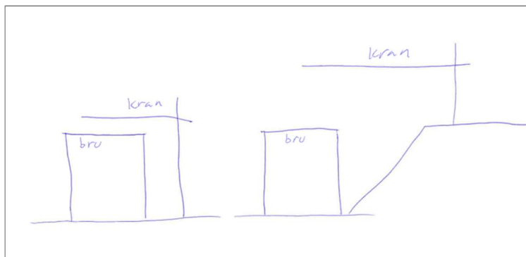
Figur 52: Lav kran til venstre, og høy kran til høyre.
