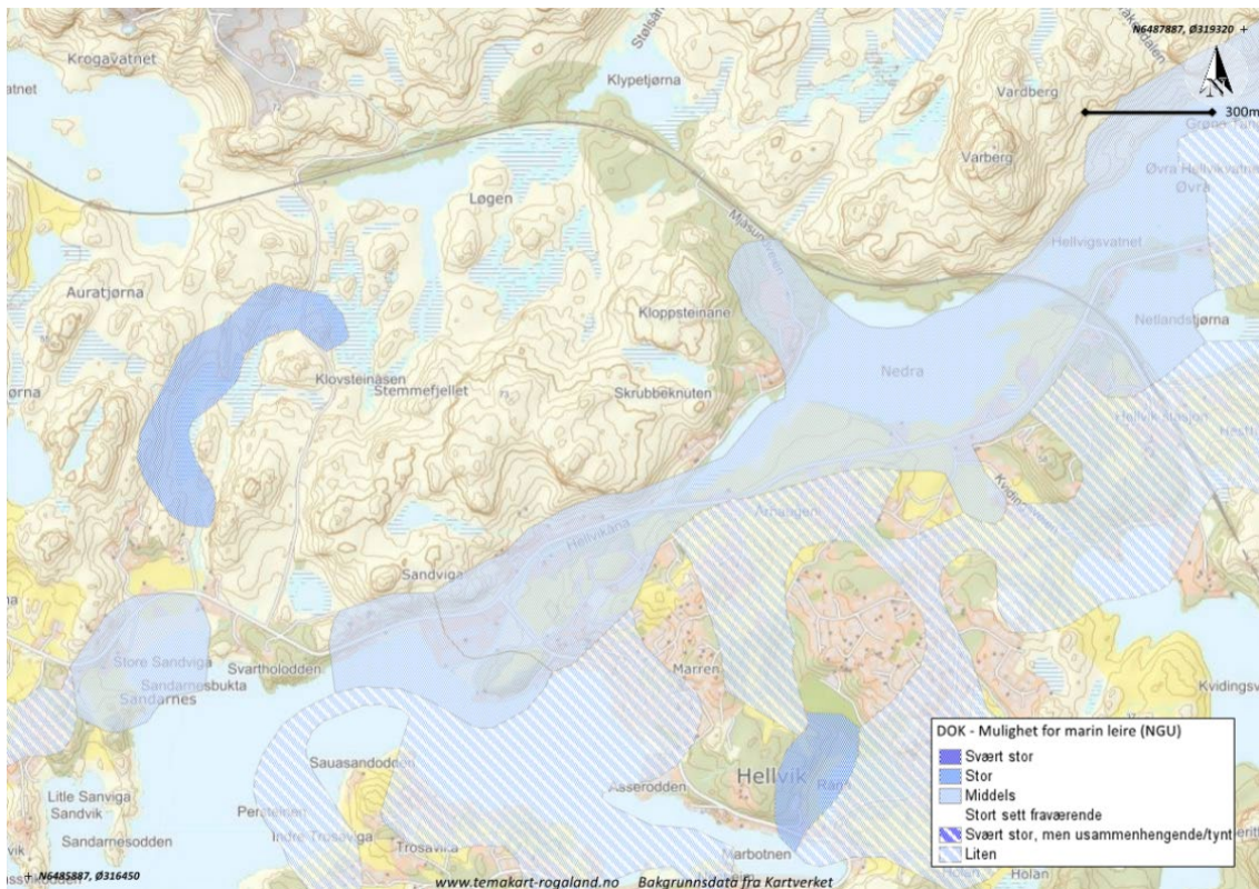
Figur 3-2: Kartutsnitt som viser kartlagt mulighet for marin leire i området (NGU) (hentet og redigert fra https://www.temakart-rogaland.no/ 09.12.2020).
