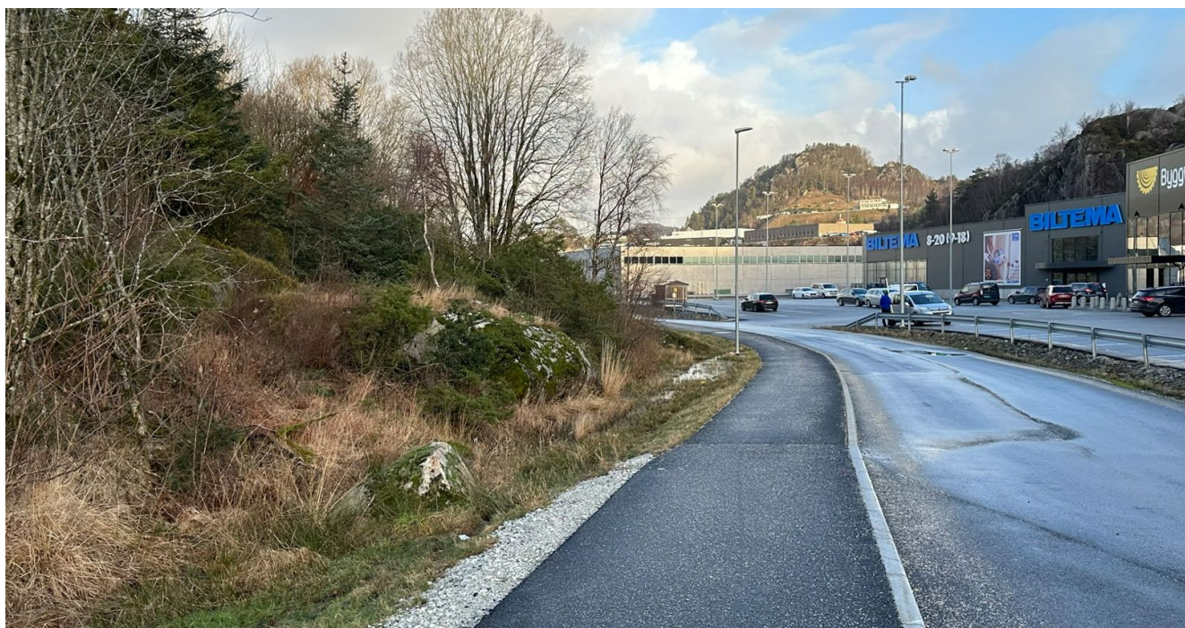
Figur 10. Bilde tatt ved Biltema i nordøstenden av planområdet. Bekrefter at området angitt som fjell består av fjell i dagen og tynt dekke. (foto: Grunnteknikk AS).
