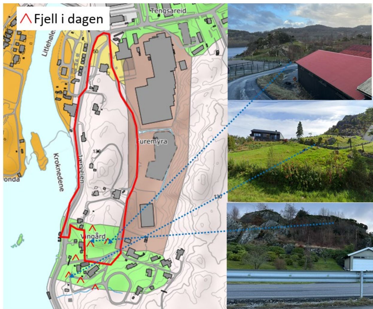
Figur 8. Utklipp av bilder fra befaring (øverst, nederst) og google streetview (midten) som viser fjell i dagen i området. Påtegnet observasjoner på NGUs løsmassekart.
