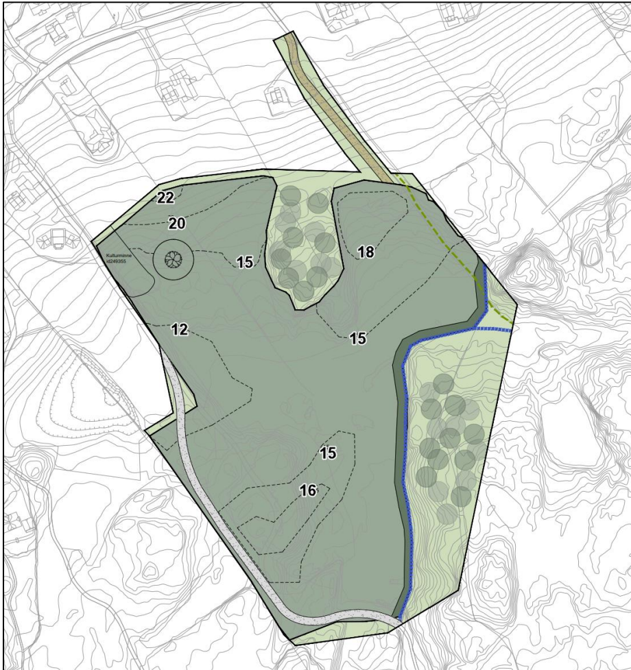
Figur 8. Forslag til oppfylling av masser tilpasset eksisterende terreng.
