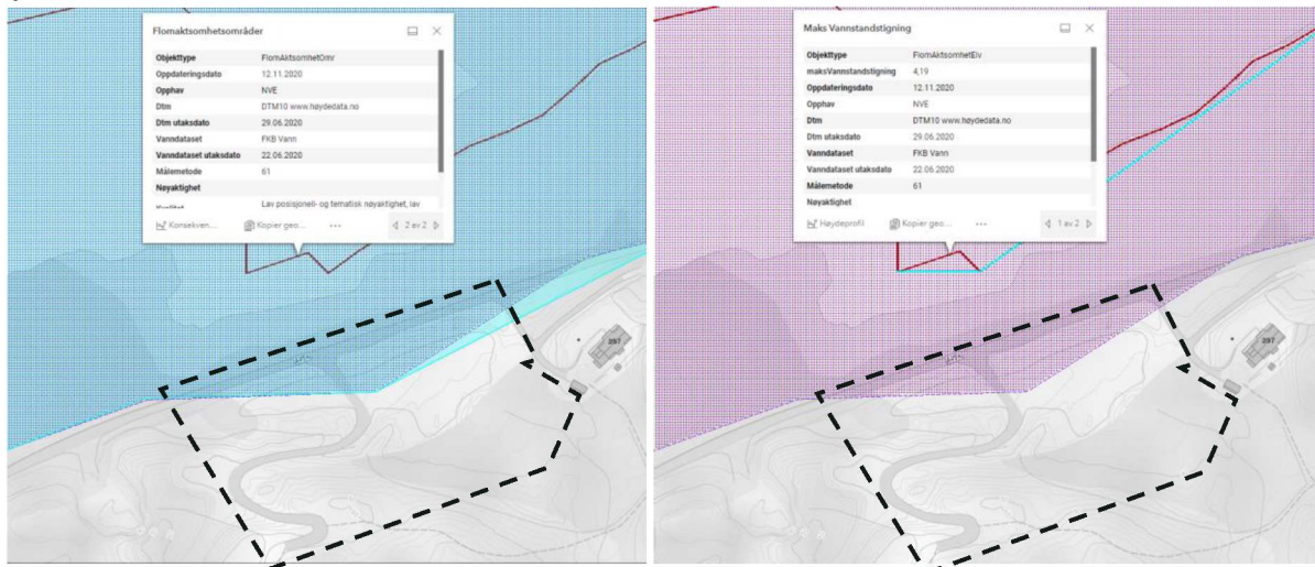
Figur 15: NVE aktsomhetskart for 200-års flom (til venstre) og maksimal vannstandstigning ved 200 års flom (til høyre). Plangrensen er vist med svart stiptet strek. Kartkilde: temakart.nve.no/flomaktsomhet
