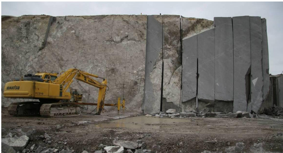
Figur 2.2. Palledrift vest i uttaksområdet, pallene sages ved hjelp av diamantwiresager og sprenges løs.
