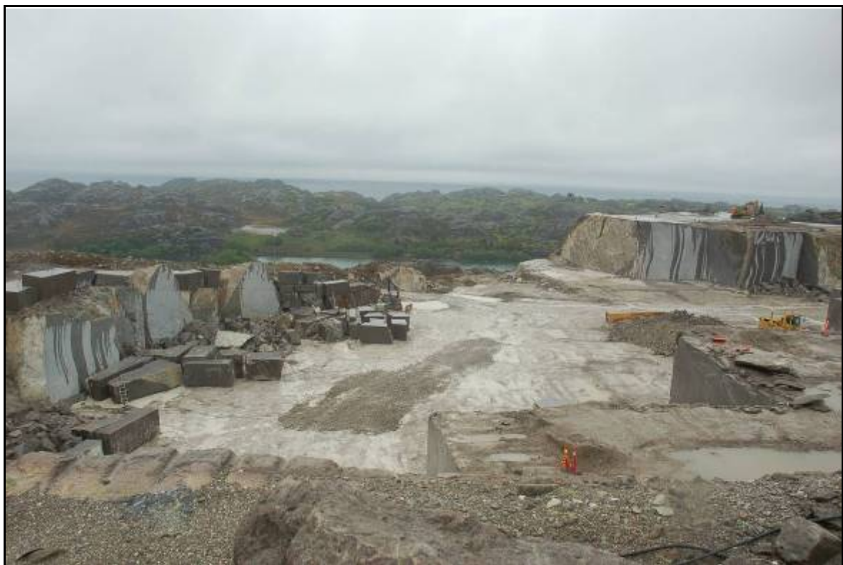
Figur 88. Grunnen består i stor grad av bergarten anortositt, som er grunnlaget for de drivverdige forekomstene i området. Her fra eksisterende steinbrudd i Hellvik.
