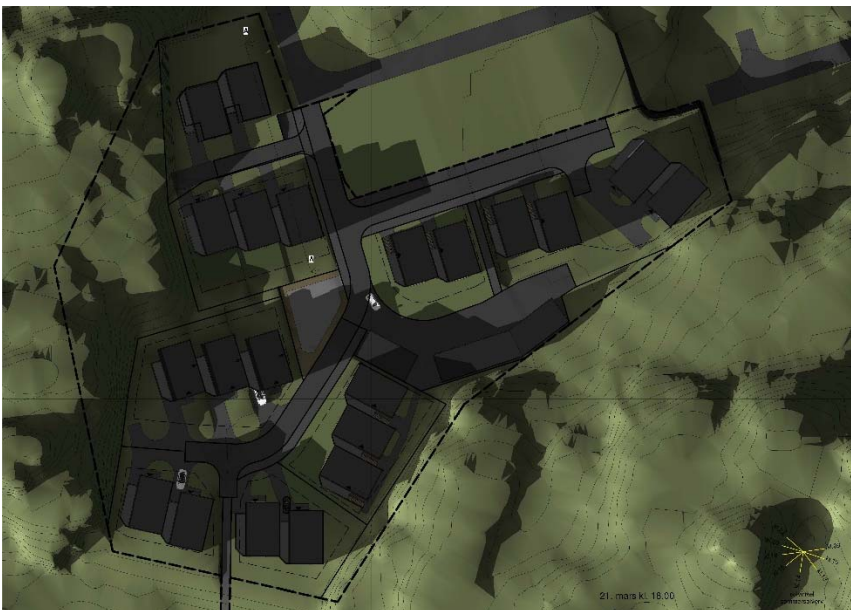
Figur 8: Soldiagram ved vår- og høstjevndøgn, kl. 18. Lite sol i området da solen er gått ned bak terrenget vest for planområdet.
