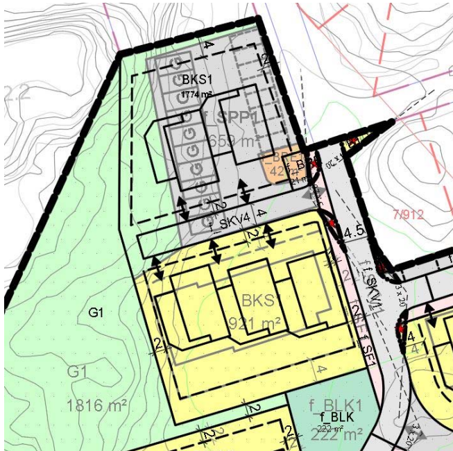
Figur 5: Utsnitt av planforslaget på gjeldende reguleringsplan. Felles parkering SPP1 erstattes av byggeområde BKS1. Byggegrenser mot SKV1 og BLK videreføres.
