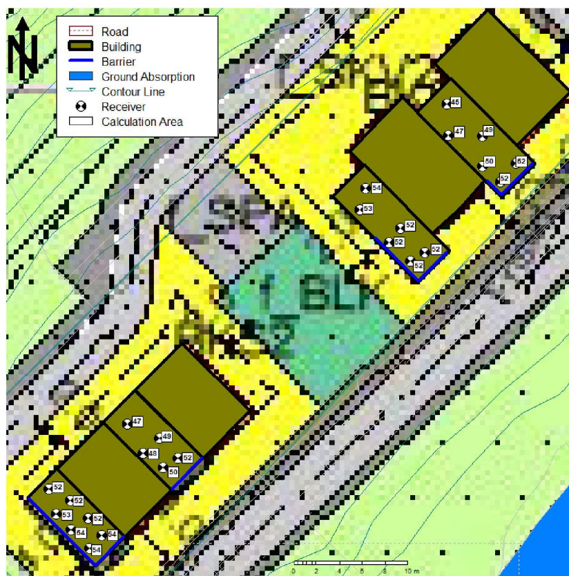
Figur 4: Mjåsundvegen gnr. 60, bnr. 134 og 135. Trafikkestøy L den [dB] på takterrasse (1,5 m over golv) med 1,2 m høyt tett rekkverk på kanten av takterrasse.
