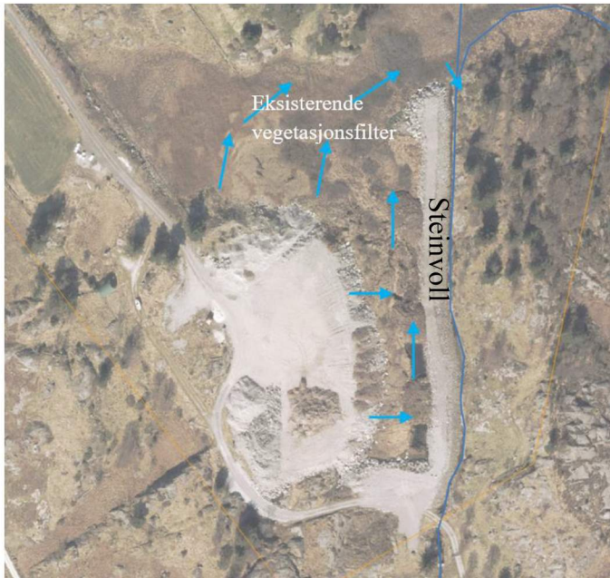
Figur 7-2. I dag ledes overvannet gjennom et vegetasjonsfilter før det havner i bekken. Etter hvert som utfyllingen brer seg utover vil størrelsen på vegetasjonsfilteret avta og dermed også rensegraden.
